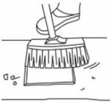
A superfície que receberá a impermeabilização deverá estar limpa, sem partes soltas ou desagregadas, nata de cimento, óleos, desmoldantes ou qualquer tipo de material que possa prejudicar a aderência. Regularizada em argamassa com boa resistência, quando em estrutura de concreto recomenda-se a lavagem com escova de aço e água ou jato d'água de alta pressão.
